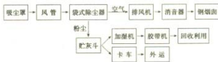
图 11-1 原料准备系统除尘工艺流程图
