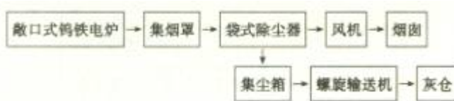
图 11-19 钨铁电炉废气治理工艺流程图
